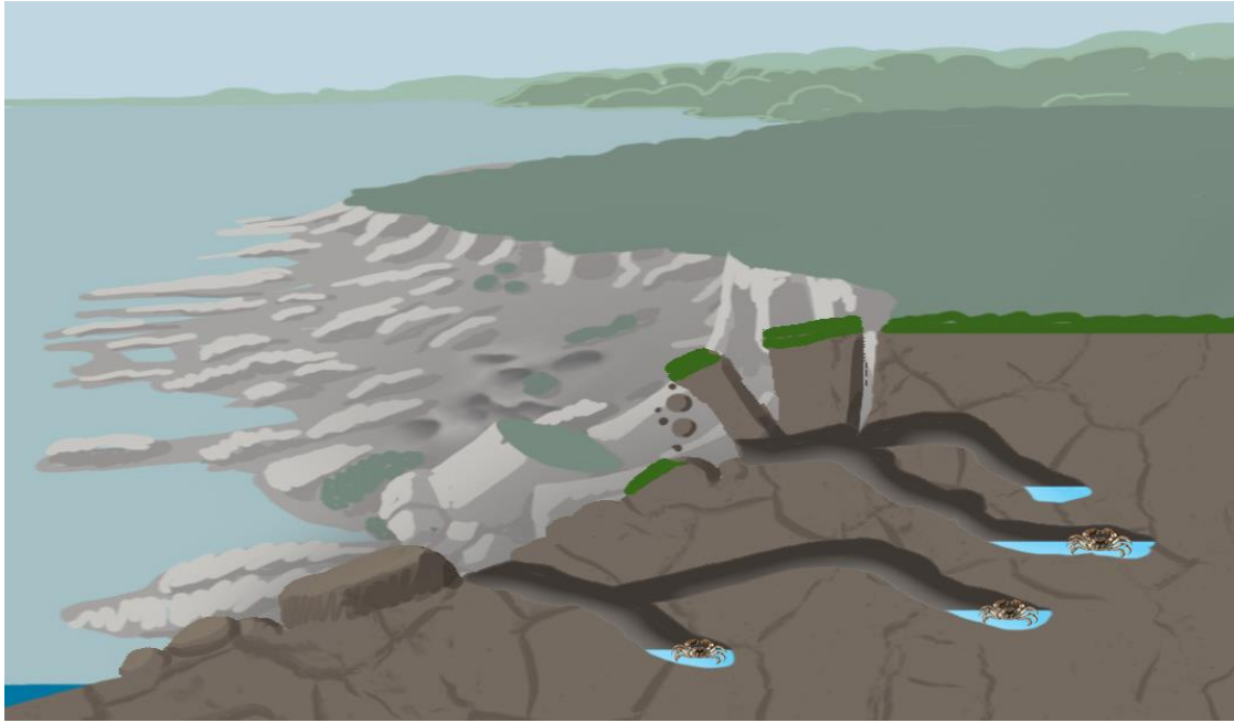
Fig 4. Erosão das margens acelerada pelas tocas de E. sinensis .
